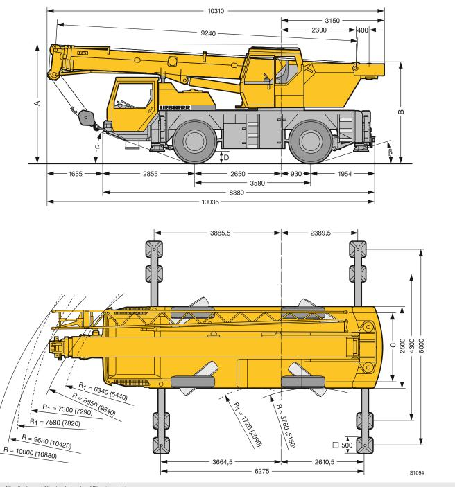
R, = Allradlenkung / All-wheel steering / Direction toutes roues () = Bereifung 16.00 R 25 / Tyres 16.00 R 25 / Pneumatiques 16.00 R 25
